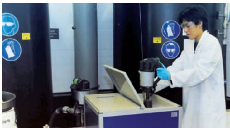
Schutzbrille und Handschuhe sind Pflicht beim Entsorgen von Lösungsmitteln. (Bild Peter Rüegg/ETH Zürich)
